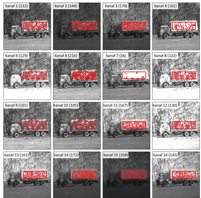
Ryc. 1. Wyniki detekcji punktów charakterystycznych w 16 kanałach pozyskiwanych za pomocą kamery spektralnej (w nawiasie podano liczby znalezionych punktów).
